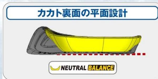
カカト部を立体的設計し平面部分を設けることで、カカトを安定させることができます。
