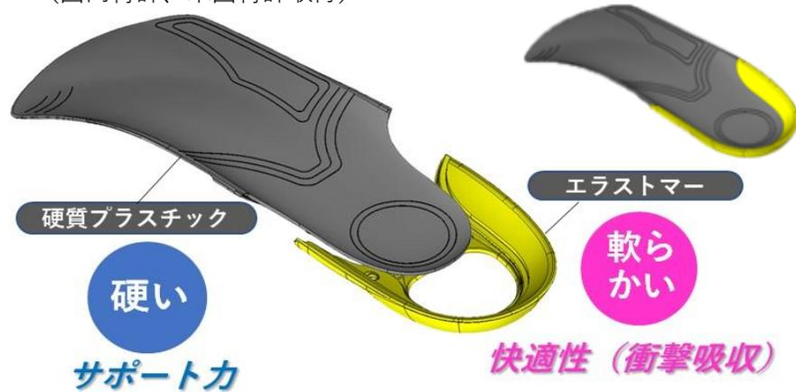
「デイリーハーフ」「アクティブハーフ」「メディハーフ」は、ダブルインジェクション製法という卓越した技術で生産されています。硬い素材（プラスチック）と軟らかい素材（エラストマー）を一体成型することで、「サポート力」と「快適性」を両立させることに成功。カカトの回内を防止できる画期的な製法です。
